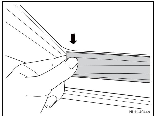
3) 将侧盖板沿导轨方向推回前玻璃下方，将侧盖板上沿卡入玻璃卡槽内。
